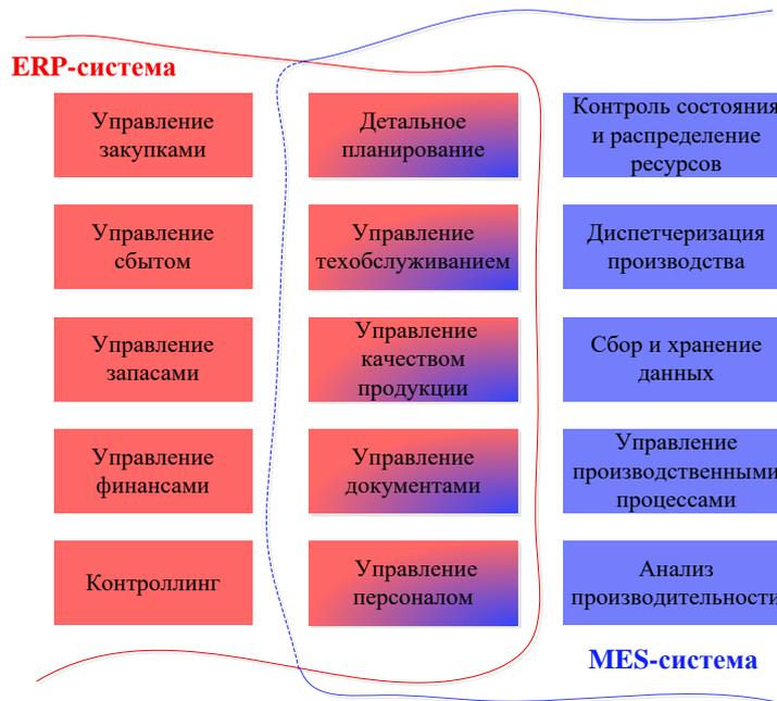
Рис.7. Функциональные возможности ERP и MES-систем
